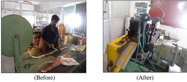
Figure 11. Cutting fins
